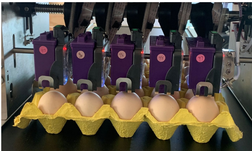
(Рис. 9) Сенсорная головка должна быть направлена перед печатающей головкой.
